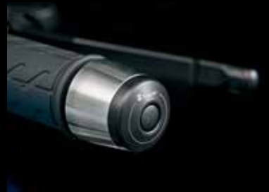
Capăt ghidon antivibrații 990D0-04K18-000 Fabricat din oțel inoxidabil cu capete de plastic, argintii cu contrast negru și sigla Suzuki.
