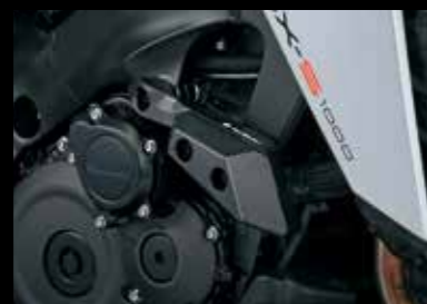
Slider cadru 99114-48K00-000 Ajută la diminuarea daunelor, fabricat din aluminiu și POM (poliacetal).
